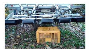
① 植付けフォークを、上方に回避しておきます(油圧固定、植付けレバー操作。田植え機取説参照)。
