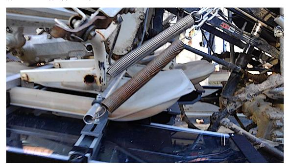
② 2種類のバネの引っ掛け位置が違うので、チェーンで長さの違いを調整してターンバックルに掛けます。チェーンの長さ・ターンバックルの長さは実地で最終調整しますが、2種類のバネにつけるチェーンの長さの違いは、保ったままにします。
